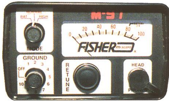
Resim 1. : M-97 KONTROL PANELİ
